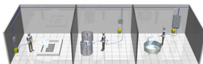
ZDECENTRALIZOWANE MYCIE RĘCZNE - Centralne lub lokalne zasilanie w substancje chemiczne
